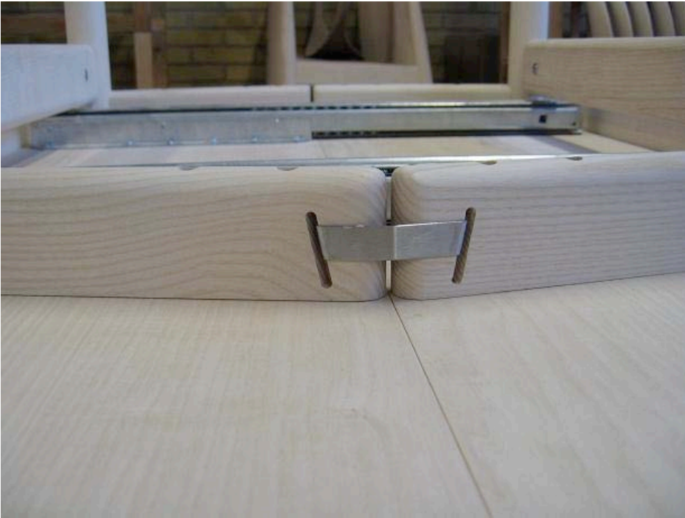
写真⑦ 固定金具をとりつける（これはエクステンションを入れるときには取り外し可能）
